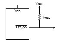
ISL706CRH, ISL705CRH FIGURE 19. RST\_OD PULL-UP CONNECTION
