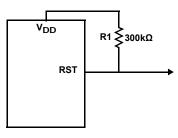
ISL705BRH, ISL706BRH FIGURE 18. RST VALID TO GROUND CIRCUIT
