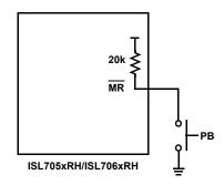
FIGURE 15. CONNECTING A MANUAL RESET PUSH-BUTTON
